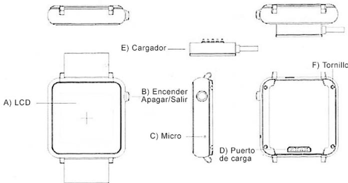
Quando cargue el reloj, el cargador magnético debe estar correctamente alineado con el reloj. Conecte primero la parte magnética con el reloj, después conecte la conexión USB a su ordenador, para prevenir cortocircuitos.
